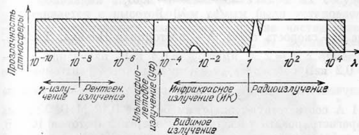
Рис. 84. Области пропускания земной атмосферой для всего диапазона электромагнитного излучения
